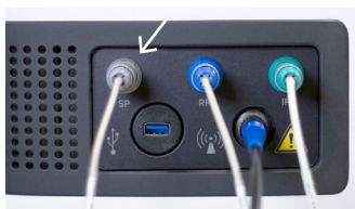
Figura 4. Collegamento della sonda di sicurezza pene a CoreTherm® Eagle.
