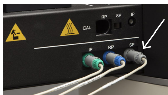
Figura 3. Collegamento della sonda di sicurezza pene a CoreTherm®/SE.
