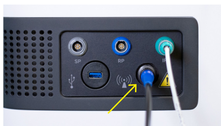
Figura 4. Collegamento dell'antenna a microonde a CoreTherm® Eagle.
