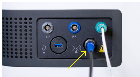
Bild 4. Ansluta mikrovågsantennen till CoreTherm® Eagle.
