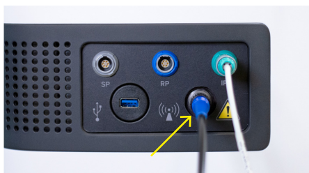
Figur 4. Tilslutning af mikrobølgeantennen til CoreTherm® Eagle.
