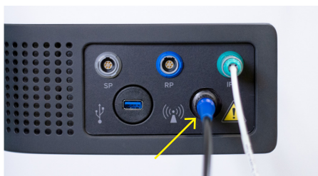
Bilde 4. Koble mikrobølgeantennen til CoreTherm® Eagle.
