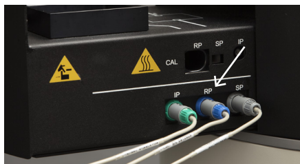
Bild 4. Ansluta den rektala temperatursonden till CoreTherm®/SE.
