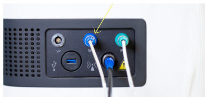
Figura 3. Collegamento della sonda di temperatura rettale a CoreTherm® Eagle.
