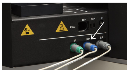
Bilde 4. Koble rektaltemperaturproben til CoreTherm® / SE.
