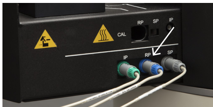
Figur 4. Tilslutning af rektaltemperatursonden til CoreTherm®/SE.
