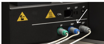
Figura 4. Collegamento della sonda di temperatura rettale a CoreTherm® / SE.
