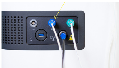
Bild 3. Ansluta den rektala temperatursonden till CoreTherm® Eagle.
