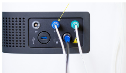
Bilde 3. Koble rektaltemperaturproben til CoreTherm® Eagle.
