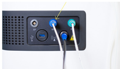
Figur 3. Tilslutning af rektaltemperatursonden til CoreTherm® Eagle.
